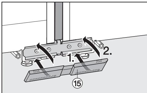
■ Sprijinirea ușilor aparatelor cu piciorul de reglare Ⓐ pe cuzinetul balamalei: Deșurubați piciorul Ⓐ până când atinge pardoseala. Apoi deșurubați piciorul cu încă 90°.
