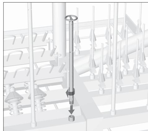
Per il trattamento di un soffietto sostituire l'ugello iniettore E 466 con un ugello iniettore per soffietti E 431 con anello di supporto più grande.
