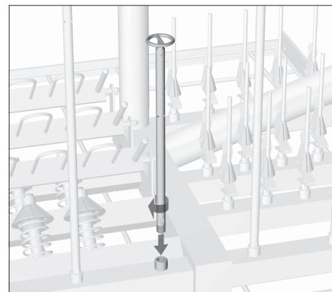
Per il trattamento di un soffietto sostituire l'ugello iniettore E 466 con un ugello iniettore speciale per soffietti E 431 con anello di supporto più grande.
