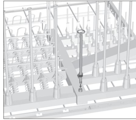
Voor de behandeling van balg-elementen moet u een inspuiter E 466 vervangen door een speciale inspuiter E 431 (met een grotere ring).
