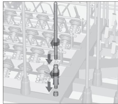
Voor het reinigen van larynxmaskers moet een speciale inspuitercombinatie van E 464 en E 454 worden gebruikt (niet bijgeleverd).
