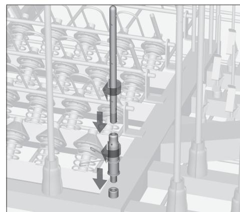
Für die Reinigung von Larynxmasken, wird eine spezielle Düsenkombination aus E 464 und E 454 benötigt (nachkaufbares Zubehör).
