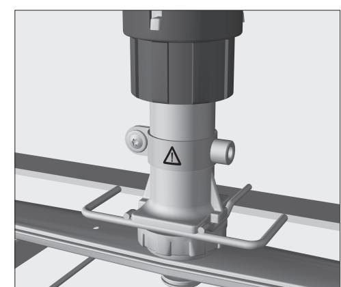
**Definierad mätpunkt för spoltrycks-mätningar exempelvis gällande effektkontroller och valideringar enligt DIN EN ISO 15883**
