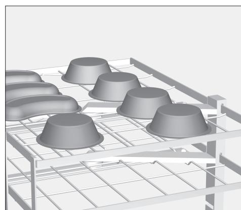
■ Les récipients comme les boîtes, les bechers, les haricots doivent être rangés avec l'ouverture vers le bas de façon à ne pas gêner et à ne pas être renversés.
