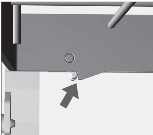
Os ganchos de encaixe situados na base da moldura do módulo encaixam nos dois lados por trás do perno da calha do carro.
