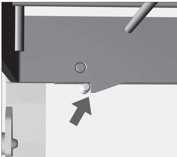
Los ganchos de la parte inferior del marco del módulo se acoplan a ambos lados detrás de los pasadores del carril guía del carro.
