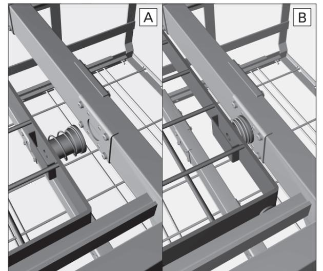
Nos módulos com tubos de passagem de água integrados o seu posicionamento fica assegurado através do correcto posicionamento do módulo.
