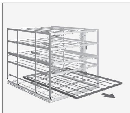
Die zweite und vierte Ebene des Wagens sind herausnehmbar. Dadurch wird bei Bedarf die Beladungshöhe der Ebenen 1 und 3 vergrößert.
