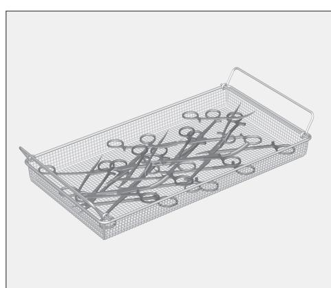
■ Les instruments à articulations doivent être déposés dépliés dans les compléments à mailles.
