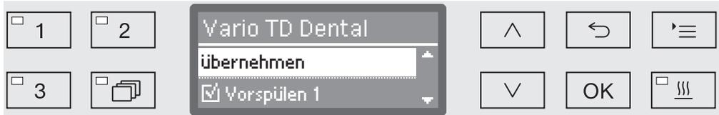
Die Zuordnung erfolgt über Mehrfachauswahl. In der Displayanzeige ist allen Spülblöcken ein Kästchen  vorangestellt. Ist der Spülblock dem Programm zugeordnet, ist darin ein Haken zu sehen . Durch Auswahl der Spülblöcke können diese dem Programm zugeordnet oder die Zuordnung wieder entfernt werden.
