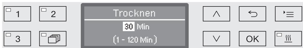
Im Display wird dazu die für dieses Programm voreingestellte Trocknungszeit in Minuten (Min) ausgegeben. In der untersten Zeile ist der mögliche Einstellungsbereich angegeben.
