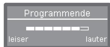
Der Lautstärkegrad wird durch eine Balkenanzeige dargestellt. In der niedrigsten Einstellung ist das Summersignal ausgeschaltet.
