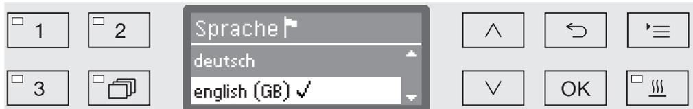
Im Display werden die hinterlegten Sprachen aufgelistet. Die aktuell ausgewählte Sprache ist mit einem Haken ✓ gekennzeichnet.
