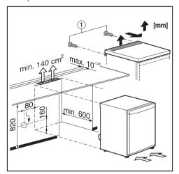
Per garantire la necessaria ventilazione sulla parte posteriore dell'apparecchio si dovrà prevedere nel piano di lavoro un'apertura di almeno 140 cm<sup>2</sup>.
