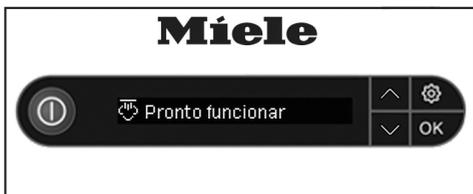
Após a colocação do reservatório de água, aguarde até a disponibilidade de vapor do sistema de engomar a vapor ser assinalada através da mensagem no visor
