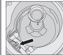
**Tipp:** Unter der Abdeckung befindet sich die Ablaufpumpe (Pfeil).
