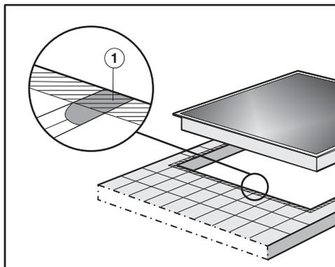
Las ranuras ① y la zona rayada situada por debajo de la superficie de apoyo de la placa de cocción deberán ser lisas y regulares para que la placa de cocción asiente de forma homogénea y la junta por debajo del borde de la parte superior del aparato garantice el sellado con la encimera.
