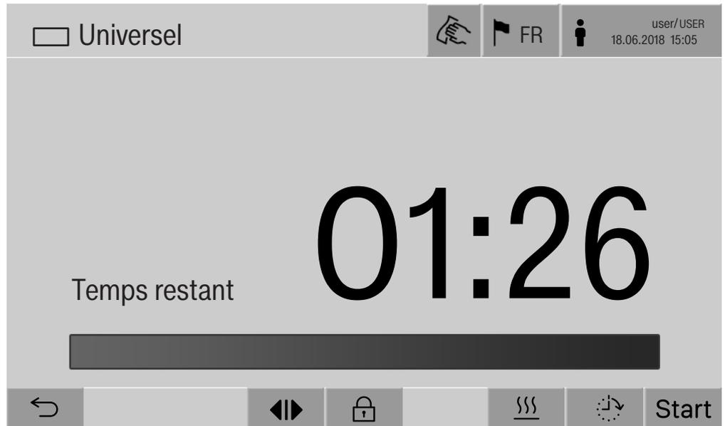
Dans l'en-tête s'affichent le pictogramme du support de chargement et le programme de retraitement sélectionné.
