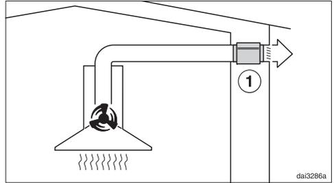
Le réducteur de bruit réduit aussi bien les bruits du ventilateur transmis à l'extérieur que ceux provenant de l'extérieur par la conduite d'évacuation (p. ex. les bruits de la rue). Pour ce faire, le réducteur de bruit doit être placé le plus près possible de la sortie d'air ①.
