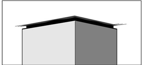
Il est possible de monter un **cadre d'espacement** entre la cheminée et le plafond. Il peut être utilisé lorsque pour des raisons esthétiques, un court espace (joint d'ombre) est souhaitable entre le plafond et la cheminée. Ceci peut notamment s'avérer nécessaire lorsque le plafond n'est pas horizontal ou est irrégulier. La verticalité de la hotte aspirante peut être ajustée avec les cales jointes. Les irrégularités visibles entre la cheminée et le plafond sont masquées par le joint d'ombre.
