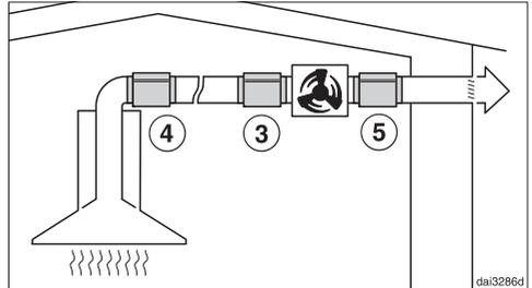
Pour réduire les bruits de ventilation dans la cuisine, le réducteur de bruit doit être positionné, si possible, devant le ventilateur externe ③, et en cas de conduite d'évacuation longue, sur le raccord de sortie d'air de la hotte ④. En cas de ventilateur externe monté dans la maison, il est possible de réduire le bruit de ventilation sortant vers l'extérieur en intégrant un réducteur de bruit derrière le ventilateur externe ⑤.
