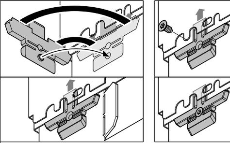
Lorsque l'écran anti-buées est tiré, la distance de sécurité par rapport à l'appareil de cuisson ne doit pas être inférieure aux valeurs prescrites. (voir "Dimensions de l'appareil"). En déplaçant l'interrupteur de fin de course, il est possible de limiter la plage réglable vers le bas.
