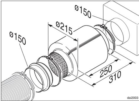
Il est possible d'installer un réducteur de bruit dans la conduite d'évacuation (accessoire en option). Il sert à réduire encore le niveau sonore de l'appareil.
