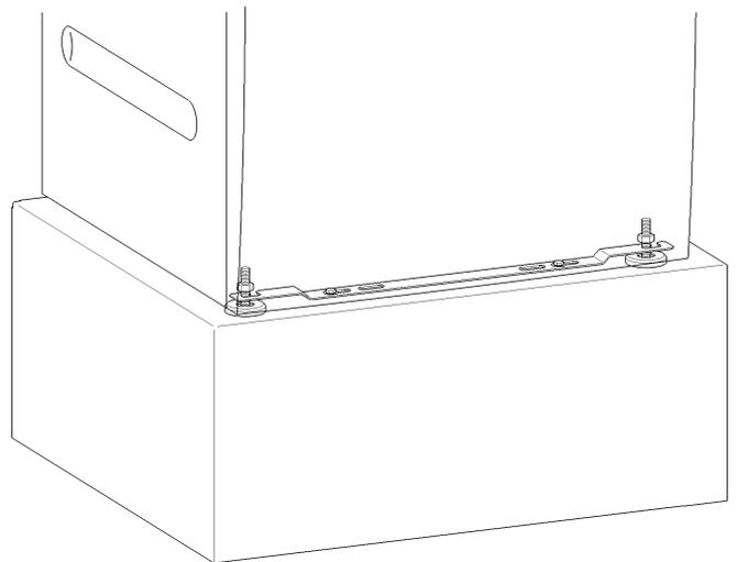
L'apparecchio viene fissato al pavimento con la staffa di fissaggio in dotazione e tramite i due piedini anteriori. Il materiale di fissaggio è predisposto per il fissaggio con perni sul pavimento in cemento.
