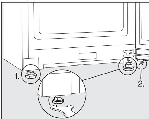
■ Mettez la cave à vin à niveau à l'aide d'un niveau à bulle et de la clé plate fournie et soutenez la porte de l'appareil.
