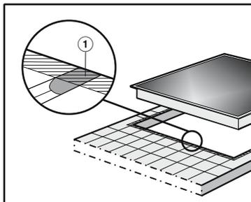
► La surface des joints ① et de la partie hachurée située sous la surface d'appui de la table de cuisson doit être lisse et parfaitement plane de sorte que le plan de cuisson repose bien à plat et que la bande d'étanchéité insérée sous le bord de la partie supérieure de l'appareil assure une bonne étanchéité par rapport au plan de travail.
