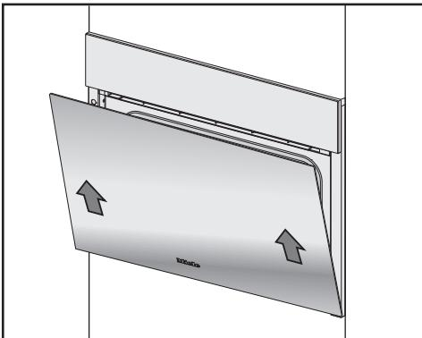
Si les étriers de blocage ne sont pas bien verrouillés, la porte risque de sortir des supports et d'être endommagée.
