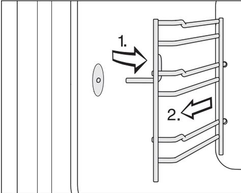
■ Sortez les supports de gradins de la fixation par l'avant (1.) et retirez-les (2.).
