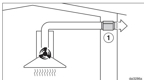
Con il funzionamento a evacuazione il silenziatore attutisce i rumori dell'aspiratore verso l'esterno e anche i rumori che dall'esterno penetrano in cucina attraverso il condotto di sfiato dell'aria (ad es. i rumori del traffico). Posizionare il silenziatore il più vicino possibile al bocchettone di uscita dell'aria ①.
