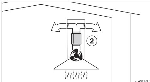
Con il funzionamento a ricircolo posizionare il silenziatore tra il bocchettone uscita aria e il deviatore ②. Controllare lo spazio di montaggio.
