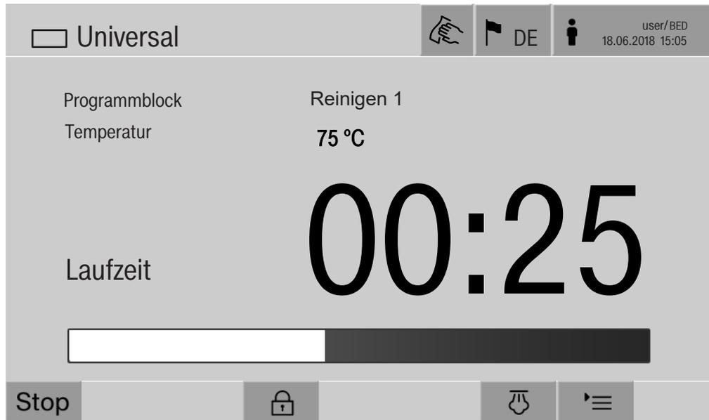
Im Display werden zusätzlich der aktuelle Programmblock und die erreichte Temperatur angezeigt.
