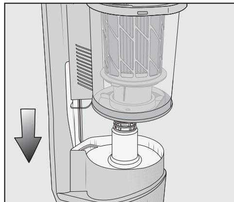
■ Führen Sie den Griff des Staubbehälters von oben entlang der Führung auf den Stutzen der PowerUnit, bis der Staubbehälter deutlich einrastet.
