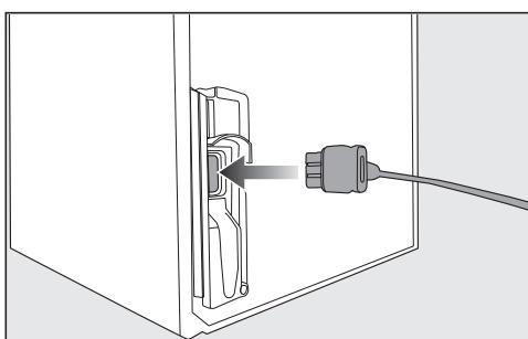
■ Τοποθετήστε το φίς της συσκευής στην πίσω πλευρά του ψυγείου.
