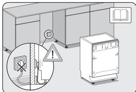
**PRECAUCIÓN:** Antes de realizar la instalación eléctrica, desconecte el suministro eléctrico ya sea quitando el fusible, desconectando el suministro principal de electricidad o „botando“ manualmente el disyuntor.
