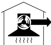
L'air est aspiré à l'intérieur de la hotte de ventilation et nettoyé par les panneaux à extraction latérale ainsi que les filtres à graisses pour ensuite être renvoyé à l'extérieur.
