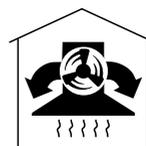
L'air est aspiré à l'intérieur et est d'abord nettoyé par les panneaux à extraction latérale puis par un filtre à graisses et ensuite par un filtre anti-odeur à charbon actif. L'air propre est ensuite recirculé dans la cuisine.
