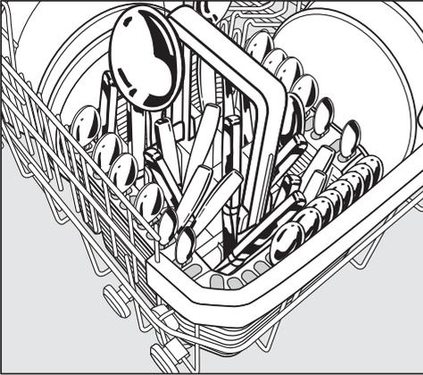
Pode colocar o cesto para talheres nas filas de ganchos dianteiras à esquerda ou à direita nos cantos do cesto inferior.
