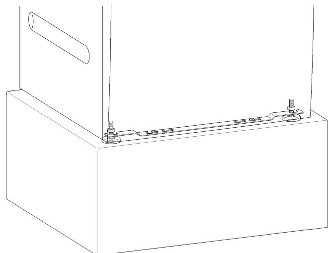
L'apparecchio viene fissato al pavimento con la staffa di fissaggio in dotazione e tramite i due piedini anteriori. Il materiale è predisposto per il fissaggio con perni su pavimentazione in cemento.
