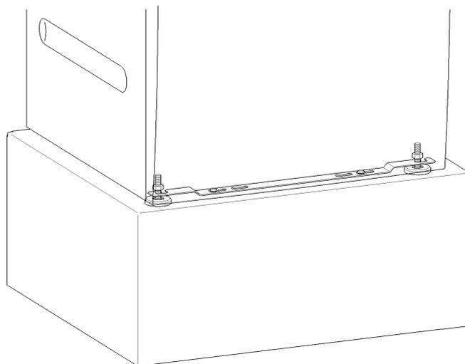
La macchina viene fissata al pavimento con la staffa di fissaggio in dotazione e tramite i due piedini anteriori. Il materiale è predisposto per il fissaggio con perni su pavimentazione in cemento.
