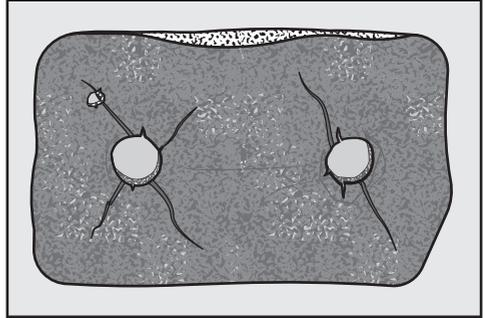
En présence de fissures et de fentes, les peluches sont entraînées dans l'échangeur thermique. À la longue, l'échangeur thermique s'encrasse.
