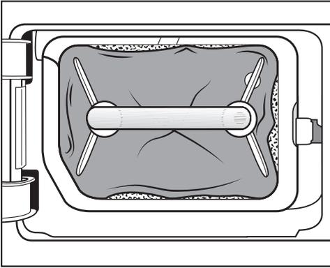
Les bords du filtre de socle ne sont pas en contact et le filtre de socle est déformé. Les peluches ne sont pas filtrées au niveau des bords et sont entraînées dans l'échangeur thermique. À la longue, l'échangeur thermique s'encrasse.
