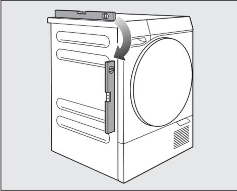
Per funzionare in modo ottimale, l'asciugatrice deve essere posizionata in bolla.
