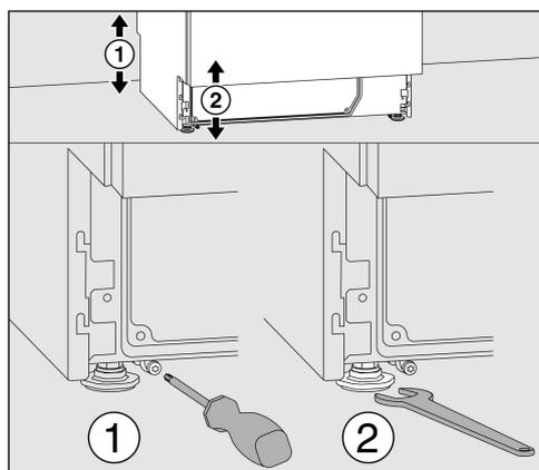
La hauteur du lave-vaisselle peut être réglée entre 820 et 880 mm (32 5/16 et 34 5/8") à l'aide des pieds de l'appareil. Les lave-vaisselle équipés d'un couvercle ont une hauteur supplémentaire de 15 mm (9/16").
