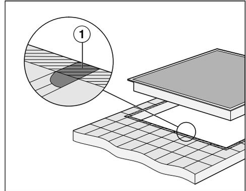
► Die Fugen ① und der schraffierte Bereich unter der Auflagefläche des Kochfelds müssen glatt und eben sein, damit das Kochfeld gleichmäßig aufliegt und die Dichtung unter dem Rand des Geräteoberteils die Abdichtung zur Arbeitsplatte gewährleistet.
