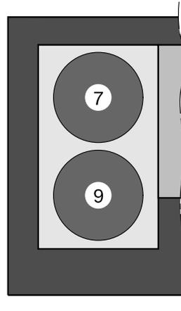
Wenn für das Kochgeschirr vorn links die Leistungsstufe 9 eingestellt ist, ist die maximale verfügbare Leistung für das Kochgeschirr hinten links die Leistungsstufe 7.
