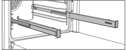
Puede montar las guías telescópicas FlexiClip en cualquier nivel.
