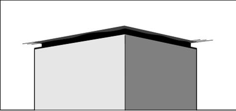
El **marco del espaciador** puede instalarse entre la chimenea y el techo. Esto crea una sombra que genera la ilusión de una ranura entre el techo y la chimenea. Resulta de utilidad si el techo no está a nivel o es desparejo. La campana se alinea verticalmente con los espaciadores suministrados. Las irregularidades visuales entre la chimenea y el techo quedan ocultas gracias a la sombra.
