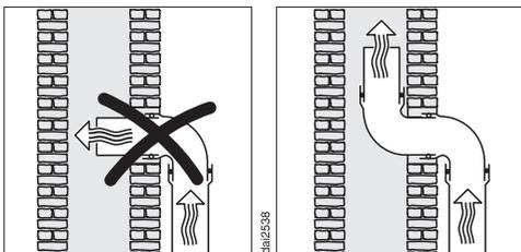
Si el aire de escape debe ser conducido a un tiro, el ducto debe alinearse con la dirección de flujo del tiro.
