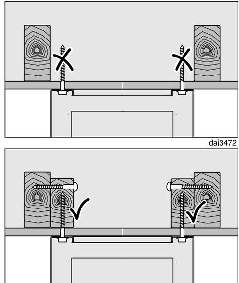
La campana debe estar sujeta a una estructura rígida que esté apoyada en su totalidad por las vigas del techo o directamente a las vigas del techo. No sujete la placa directamente al techo con anclajes, tornillos de fiador, etc.
