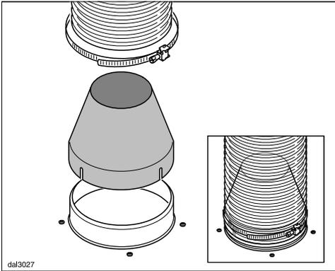
Si desea reducir el impacto medioambiental del sistema de ventilación al limitar la generación de pies cúbicos por minuto (CFM), puede instalar el collar reductor. Reduce el flujo de aire a menos de 400 CFM. Revise los códigos de construcción de su localidad para conocer los requisitos de CFM máximos.
