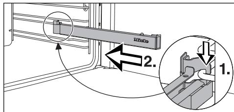
■ Hekt FlexiClip-skinnen foran på den nederste stangen i rillehøyden (1.) og skyv den langs stangen inn i ovnsrommet (2.).
