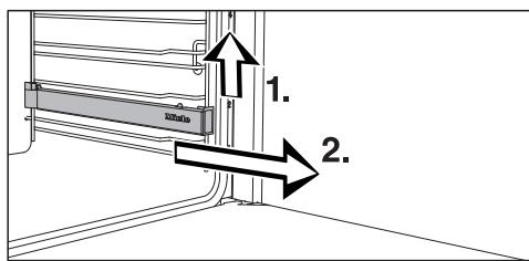
■ Løft FlexiClip-skinnen foran (1.) og trekk den ut langs stangen i rillehøyden (2.).
