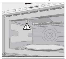
Não retire a cobertura diante da abertura de saída de micro-ondas no interior do forno.  Verifique se o aparelho está danificado.
