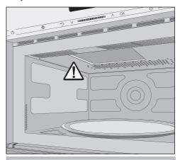
Não retire a cobertura situada no interior do forno, na zona de saída de micro-ondas.
