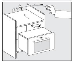
■ Deslize o aparelho de micro-ondas para o interior do nicho. Passe o cabo com a ficha através do armário.
