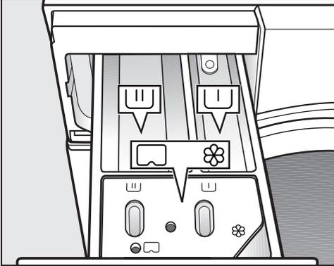
■ 拉开洗涤剂配给抽屉，将洗涤剂添加到隔间内。
