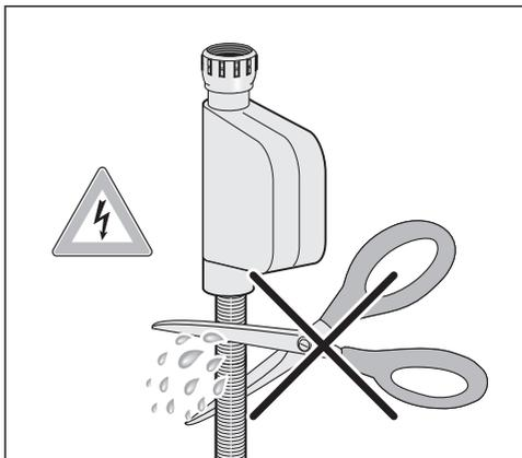
⚠ Stromschlaggefahr durch Netzspannung.
