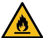
► Upozorenje: Opasnost od požara usled zapaljivih materijala. Ovaj simbol se nalazi na kompresoru i upozorava na zapaljive materijale. Nemojte da uklanjate ovu nalepnicu.
