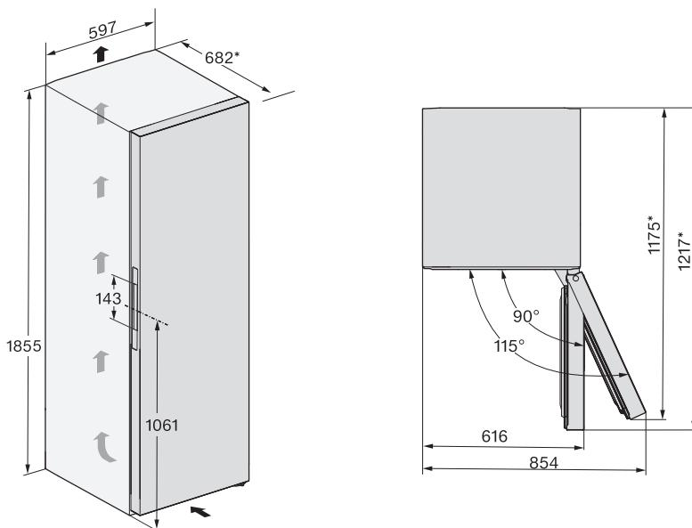
\* Dimenzije bez montiranih zidnih odstojnika. Ukoliko se koriste zidni odstojnici, povećava se dubina uređaja za 15 mm.
