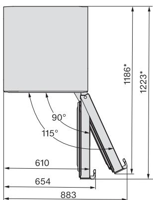
\* Dimenziije bez montiranih zidnih odstojnika. Ukoliko se koriste zidni odstojnici, povećava se dubina uređaja za 15 mm.
