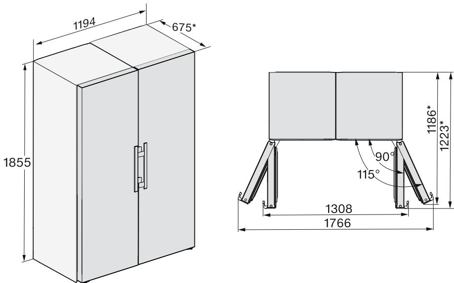
\* Dimenziije bez montiranih zidnih odstojnika. Ukoliko se koriste zidni odstojnici, povećava se dubina uređaja za 15 mm.
