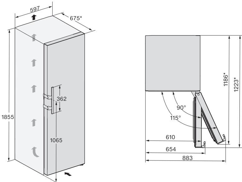
\* Dimenziije bez montiranih zidnih odstojnika. Ukoliko se koriste zidni odstojnici, povećava se dubina uređaja za 15 mm.
