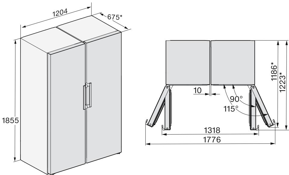
\* Dimenziije bez montiranih zidnih odstojnika. Ukoliko se koriste zidni odstojnici, povećava se dubina uređaja za 15 mm.
