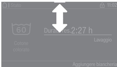
Se sul bordo superiore dello schermo al centro del display compare una barra arancione, è possibile visualizzare il menù a tendina. Toccare la barra e strisciare il dito sul display verso il basso.
