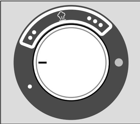
Les différents niveaux de température sont identifiés par des points sur la graduation du thermostat. Ces niveaux correspondent aux symboles internationaux utilisés pour le repassage.
