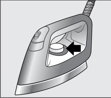
La température de repassage se règle à l'aide du thermostat situé sur le fer à repasser.
