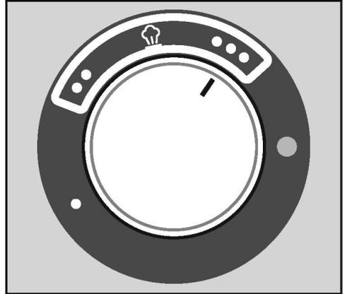
Le témoin lumineux sur le sélecteur de température s'allume en jaune pendant que le fer à repasser chauffe.
