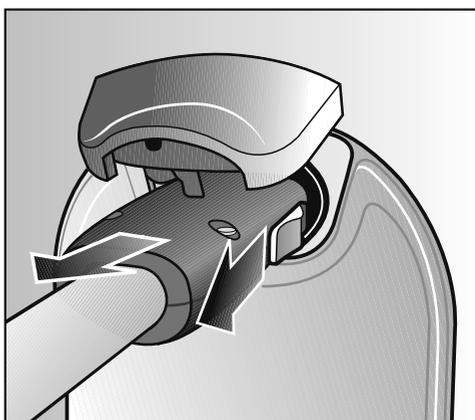
■ Tirez le curseur situé sur le côté de la prise du tuyau pour vapeur vers l'arrière.
