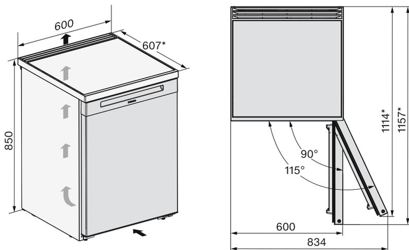
\* Dimensions sans entretoises murales montées. Si vous avez monté des entretoises, la profondeur de l'appareil augmente de 35 mm.
