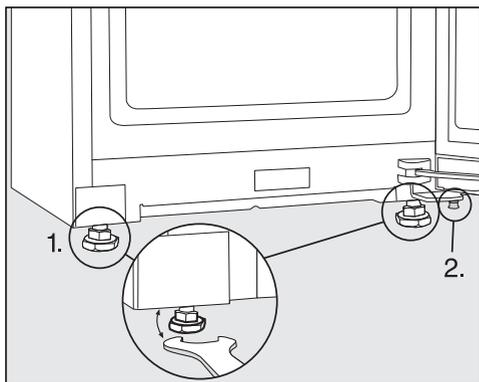
■ Mettez l'appareil de froid à niveau à l'aide d'un niveau à bulle et de la clé plate fournie et soutenez la porte de l'appareil.
