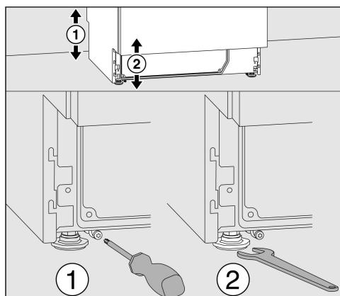
Las patas delanteras del aparato pueden ajustarse con una llave de boca (tamaño de llave 13); las traseras, con un tornillo Torx T20.
