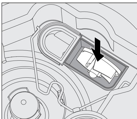
La rueda móvil de la bomba de desagüe se encuentra debajo de la válvula antirretorno.
