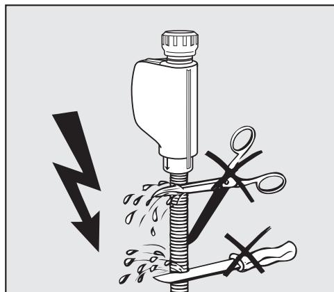
**⚠️** Las mangueras de entrada de agua **no** deben acortarse ni dañarse.
