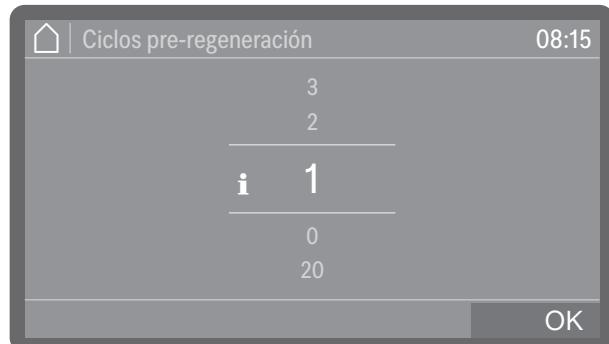
Es posible configurar con cuántos ciclos de lavado de antelación se desea que se advierta del proceso de regeneración; consultar ▶ Otros ajustes ▶ Serv. téc. y mantenim. ▶ Indicación regeneración.
