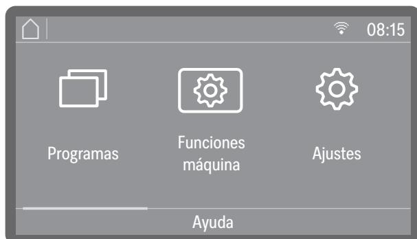
En el caso de lavadoras desinfectadoras con conectividad, en la parte superior del display aparece el ícono de la interfaz disponible. WiFi significa que hay conexión WiFi disponible; L significa que existe una conexión LAN por cable. Si la lavadora desinfectadora no puede establecer una conexión WiFi con el router, el símbolo aparece tachado.
