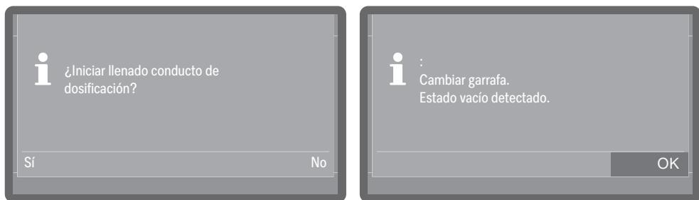
Los mensajes del sistema se indican con el símbolo **i**. Proporcionan información sobre el proceso en curso y el estado del aparato. Si hay varios mensajes del sistema, estos se emiten sucesivamente y deben procesarse o confirmarse individualmente según el mensaje.
