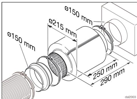
为了进一步降低噪音等级，可以在排气管中安装静音器（可选配件）。
