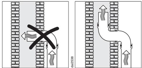
若要将废气排入烟道，必须按照烟道的流动方向引导管道。
