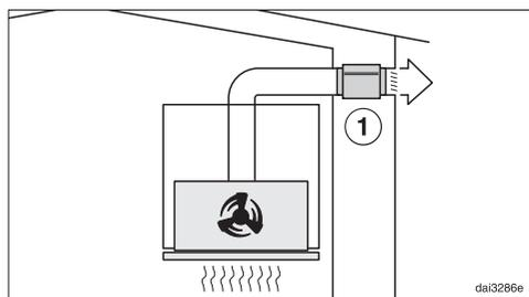
在抽气模式下，静音器不仅可以减少室外风扇产生的噪音，还可以减少从室外透过排气管传到厨房的声音（例如交通噪音）。因此，必须将静音器放置在尽可能靠近管道出口 ① 的位置。
