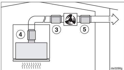
对于使用外部电机的操作，可以将室外和厨房内电机发出的噪音降至最低。将静音器放置在外部电机 ③ 前部，可以减少厨房内的噪音。如果排气管很长，则需要将静音器放置在吸油烟机上方管道中的排气管 ④ 上。对于安装在室外的外部电机，可将静音器放置在外部电机 ⑤ 后部，以此降低室外电机产生的噪音。
