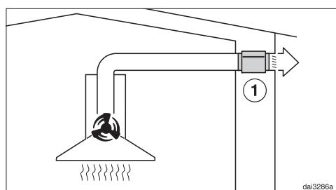
Bei Abluftbetrieb dämpft der Schalldämpfer sowohl Gebläsegeräusche nach aussen als auch Aussengeräusche, die über die Abluftleitung in die Küche dringen (z. B. Straßenlärm). Dazu wird der Schalldämpfer möglichst nah vor dem Abluftaustritt ① positioniert.
